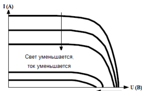
Связь между выходными характеристиками солнечной панели и светом
