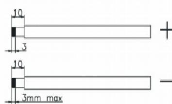
подключить положительный контакт (+) кабеля солнечных батарей PV к положительной клемме (+) входа PV устройства. Подключить отрицательный контакт (-) кабеля солнечных батарей PV к отрицательной клемме (-) входа PV устройства.
