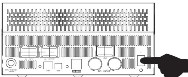
После того, как устройство было надлежащим образом установлено и к нему были соответствующим образом подключены аккумуляторные батареи, просто нажмите на кнопку On/Off (Вкл. / Выкл.), расположенную в нижней части корпуса, чтобы включить устройство
